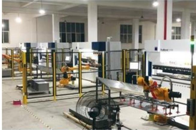
Com base na rica experiência acumulada no campo da automação de processamento de chapas metálicas e processo de dobra, um software de dobra especial Smart Robot Bending é desenvolvido no sistema de controle numérico de dobra e sistema de controle de robô, que resolve o problema de dobra após desvio causado por alta aceleração no processo de dobragem de chapas metálicas e longo tempo de ensino.
